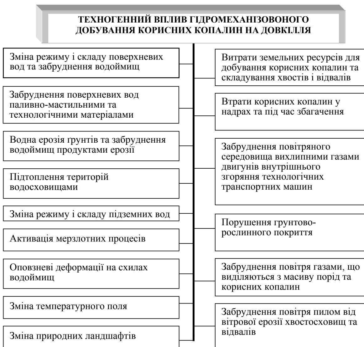
Рис. 2.7. Вплив на довкілля від розроблення родовищ гідромеханізованим способом
