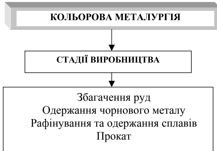
Рис. 4.8. Схема стадій виробництва кольорових металів та їх сплавів
