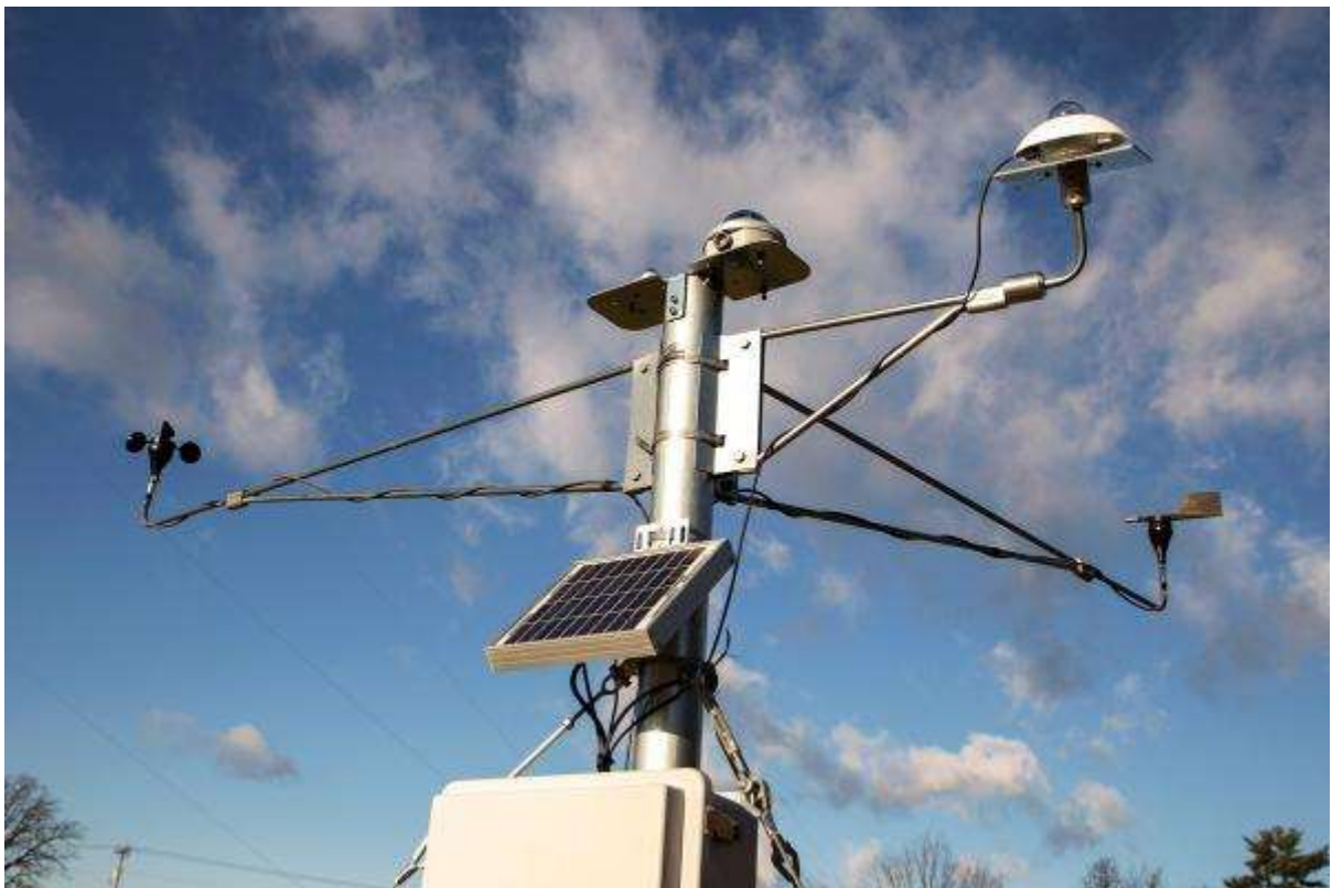
Рис. 7.1. Вимірювальна метеорологічна система RNRG SRA
