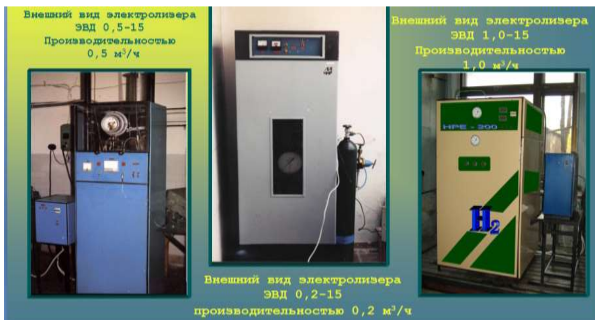
Рис. 10.4. Електролізери високого тиску розробки ІПМ ім.Підгорного
