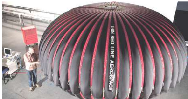
Рис. 16.2. Резервуар для зберігання стисненого повітря
