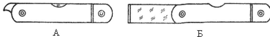
Рисунок 3 - Таксаційний приціл (призма) Н.П. Анучіна А - у зібраному вигляді; Б - в робочому положенні
