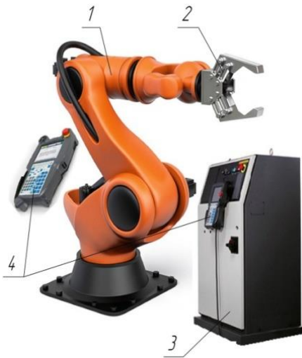
Рис.20. Промисловий робот та його складові,
