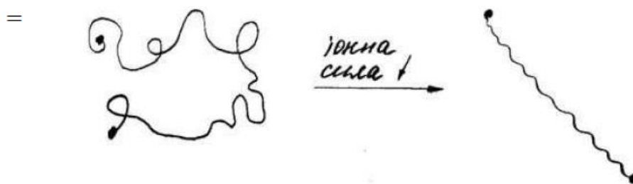
Рисунок 2 – Приклад розгорнутої конфігурації полімерного завитку
