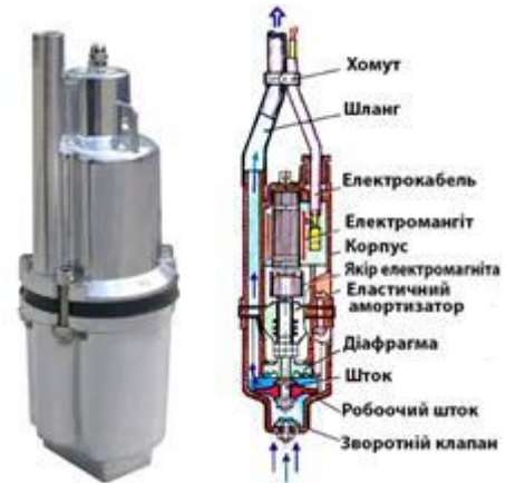
Рис. 2.11 – Вібраційний насос
