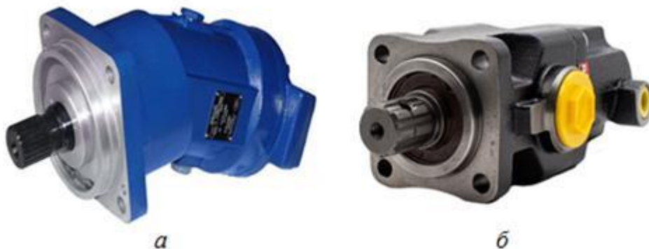
Рис. 3.8 – Аксіальнопоршневі гідромашини: а – з похилим блоком, б – з похилим диском.
