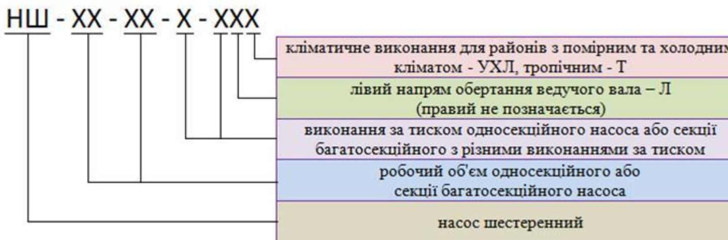
Рис. 3.29 – Структура умовного позначення шестеренних насосів
