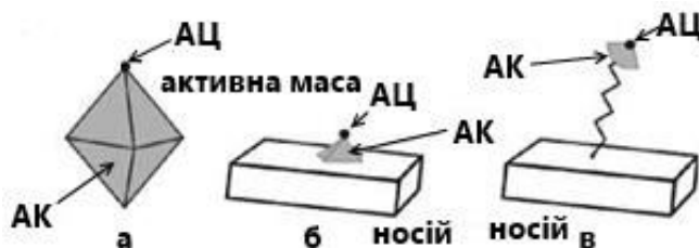
Рис. 1.4. Каталізатори: а – масивний, б – нанесений, в – закріплений, показано активний компонент (АК) та активний центр (АЦ) каталізатора
