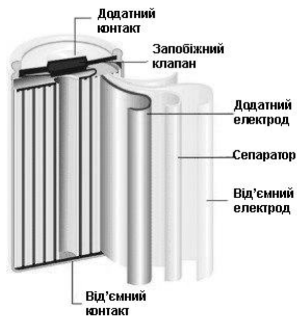
Рис. 2.3. Конструкція циліндричного NiCd акумулятора
