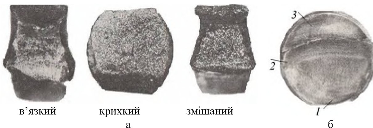
1 – зона зародження тріщини; 2 – зона поширення тріщини; 3 – зона доламу Рис. 7.2. Злами сталі (а) та штока компресора від втоми (б)
