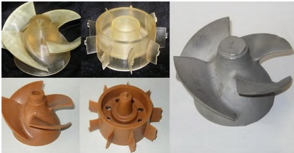
Рис. 8.2. Пластикові стереолітографічні моделі робочих коліс для водометних рушіїв, виготовлені за ним воскові моделі («восківки») та готовий металевий виливок
