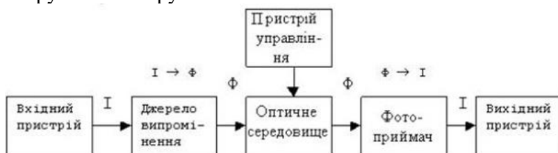
Рисунок 8.2 - Узагальнена структурна схема оптрона
