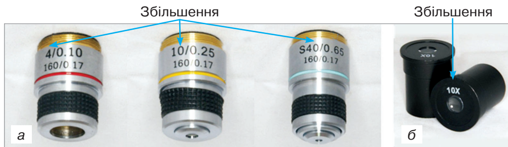
Мал. 7. Об'єктиви (а), окуляр (б) шкільного мікроскопа та їх маркування
