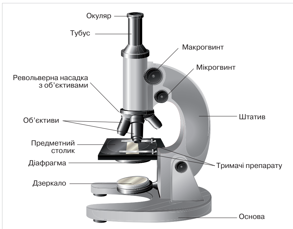
Мал. 6. Зовнішній вигляд та основні складові шкільного мікроскопа
