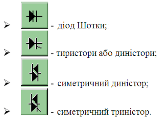
Рисунок 6.5 – Позначення моделей перемикальних діодів
