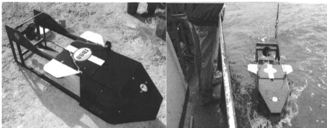
Рис. 9.5. Касетний планктонометр Мельникова-Темних
