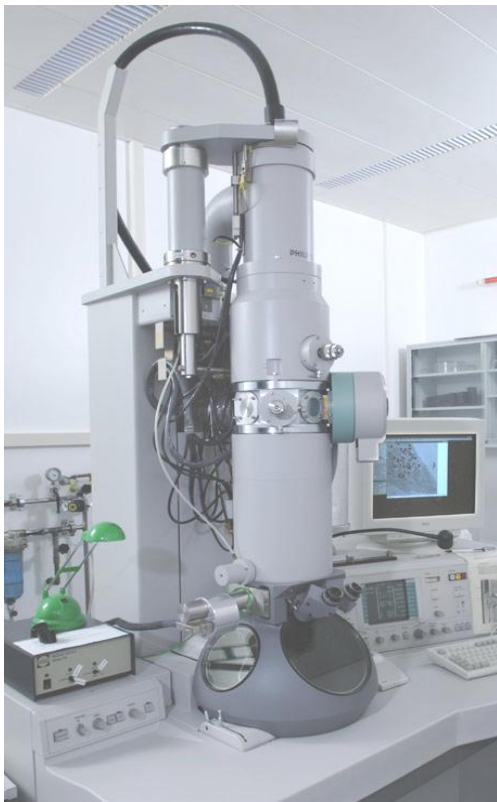
Рис. 1.7. Трансмісійний електронний мікроскоп та схематичне зображення потоку електронних променів
