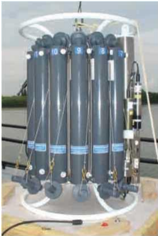
Рис.7.4. Пробовідбірники карусельного типу на 12 та 24 батометри
