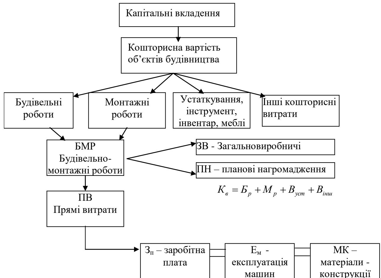
Рис. 1.1. – Схема складових частин витрат кошторисної вартості
