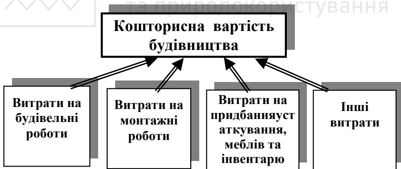
Рис. 1.5. Складові кошторисної вартості будівництва
