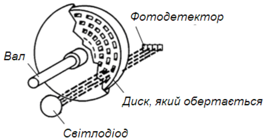
Рисунок 14.5 – Схема оптичного енкодера
