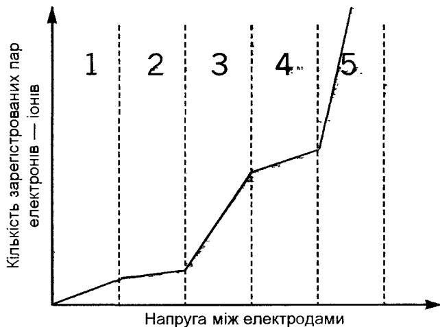
Рис. 14.2. Залежність напруги між електродами іонізаційного детектора та кількості пар електронів — іонів, які виникають при іонізації газу: 1— область рекомбінації, 2— область простої іонізації, 3 — область пропорційного рахунку, 4 — область Гейгера-Мюлера, 5 — область пезперервного розряду
