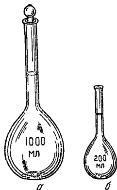
Рис. 2.7. Мірні колби а — з притертою пробкою; б — без пробки
