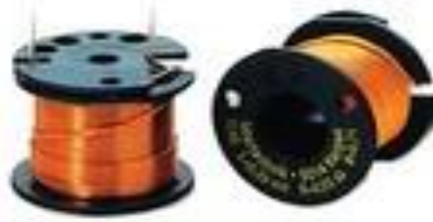
Рисунок 4.3 - Котушки індуктивності з повітряним сердечником і обмоткою з мідного витого семижилкового дроту (літцендрат) на пластиковому каркасі
