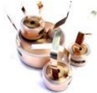
Рисунок 4.4 - Котушки індуктивності з обмоткою із фольги (розмір 74 x 27 мм 2 , індуктивність 1 мГн, опір 0,18000001 Ом)
