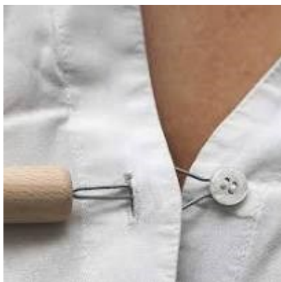
Рисунок 4.1 – Пристосування для застібання гудзиків
