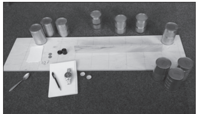
Рисунок 3. Набір для проведення тесту Джебсена — Тейлора
