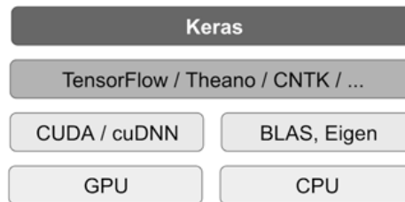
Рисунок 3.10 – Програмно-апаратний стек підтримки глибокого навчання
