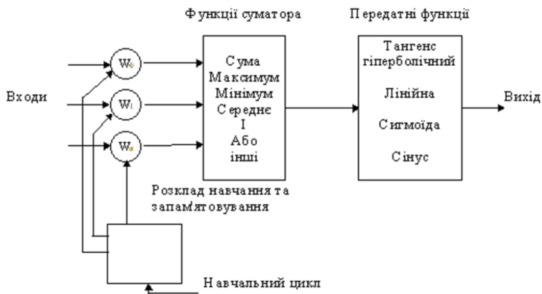
Рисунок 3.3 – Модель «елементу обробки»
