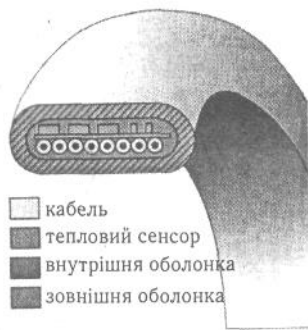
Рис. 4.32. Будова сенсорного кабелю Securі Sens TSC 511
