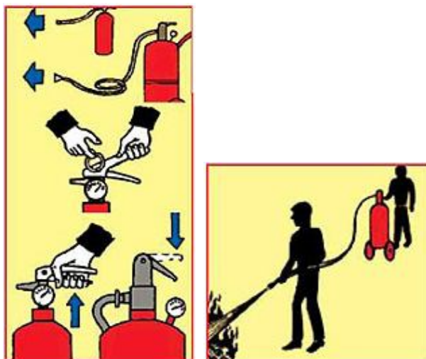
Рисунок 8.7 — Зображення дій із закачними порошковими вогнегасниками
