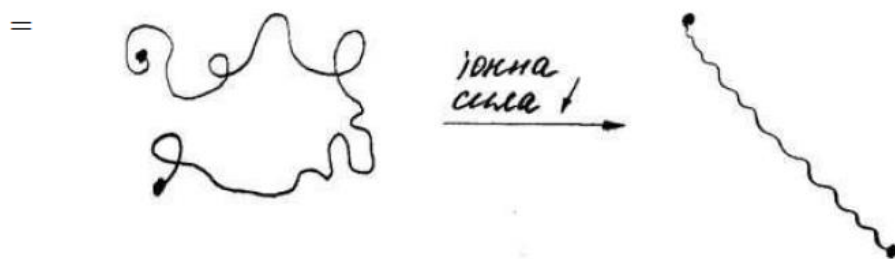
Рисунок 2 – Приклад розгорнутої конфігурації полімерного завитку
