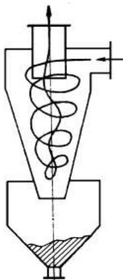
Рис. 2.3. Схема основного руху газів в циклоні
