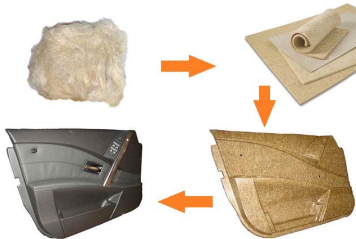
Рис. 5.44. Схема виготовлення дверної панелі з конопляних волокон
