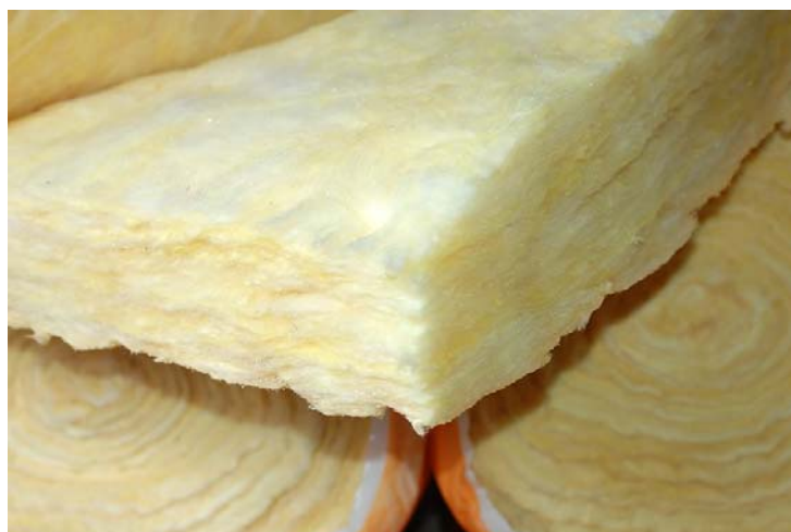
Рис. 2.45. Загальний вигляд скломату
