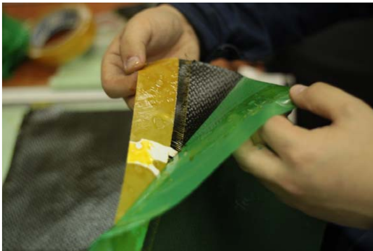
Рис. 2.50. Загальний вигляд препрегу
