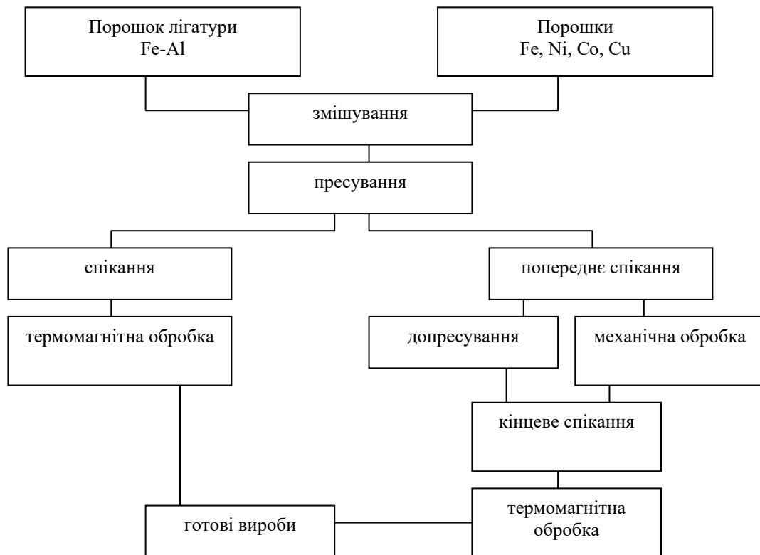
Рис. 6.35. Технологічна схема виготовлення магнітів із сплавів типу альніко
