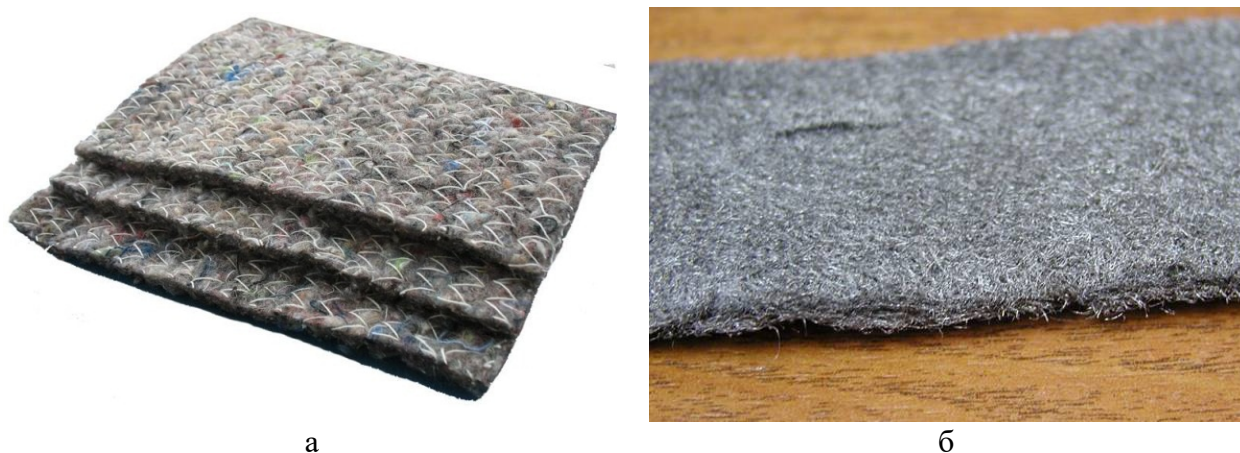
Рис. 2.44. Неткане полотно (а) та голкопробивне металеве полотно (б)
