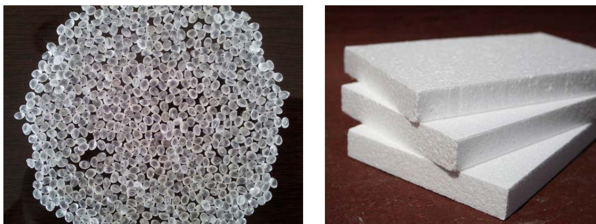
Рис. 2.14. Гранули полістиролу (а) та пінопласт полістирольний (б)
