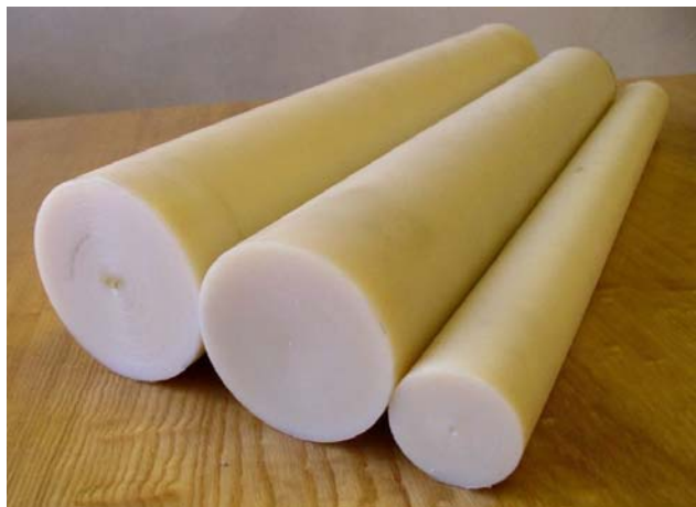
Рис. 2.19. Прутки (а) та втулки (б) з фторопласту
