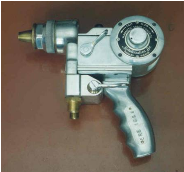
Рис. 6.4. Газополум'яний металізатор МК-40 (а) та порошковий дріт (б)
