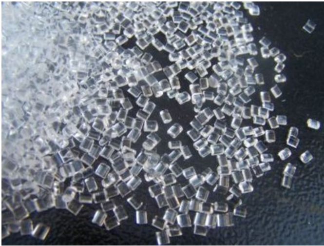
Рис. 2.15. Гранули поліметилметакрилату (а) та пластини поліметилметакрилату (б)
