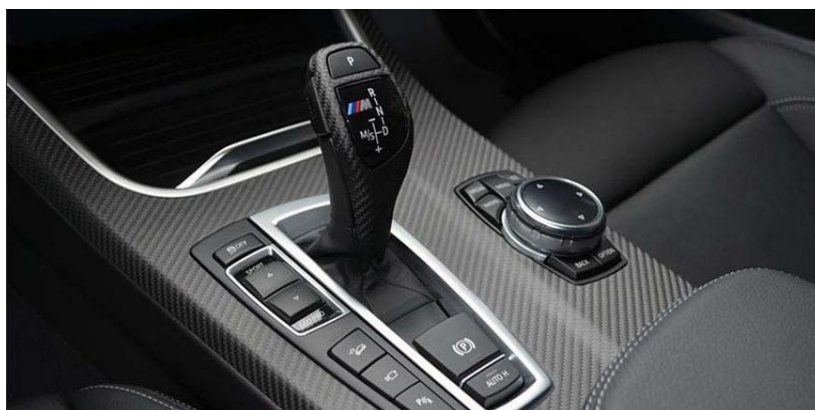
Рис. 2.61. Елементи кузова (а) та панелі салону автомобіля з вуглепластиків
