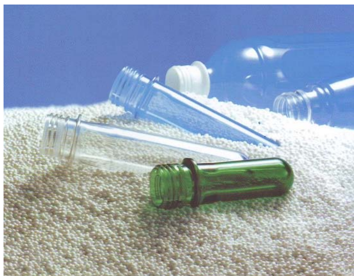
Рис. 2.16. Гранули поліетилентерфталату та заготовки для виготовлення пляшок
