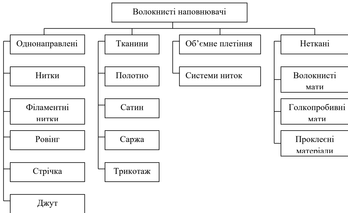
Рис. 2.21. Основні види волокнистих наповнювачів армованих пластиків
