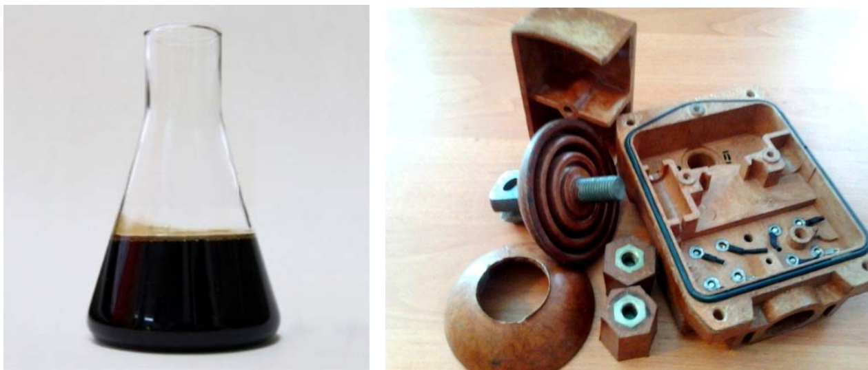
Рис. 2.7. Загальний вигляд фенолформальдегідної смоли (а) та вироби з фенопластів (б)
