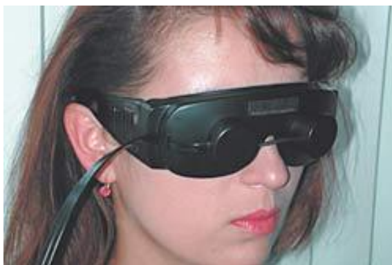
Рисунок 1.12 - Очки к фотостимулятору для определения КЧСМ
