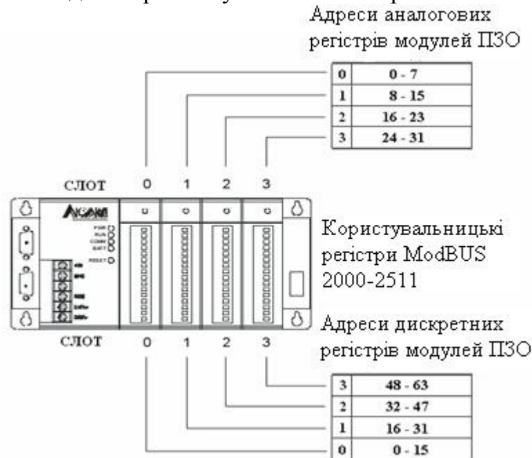
Рисунок 12.14 – Адресація регістрів модулів ПЗО серії «ADAM5000»
