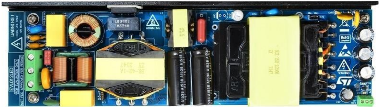
Рисунок 4.2 – Резонансний LLC перетворювач EVL012LED фірми STM.
