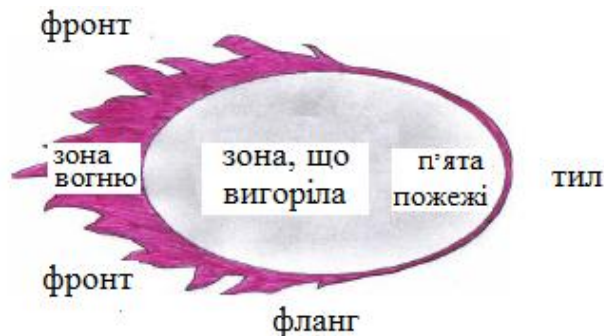
Рисунок 7 – Схема типової лісової пожежі
