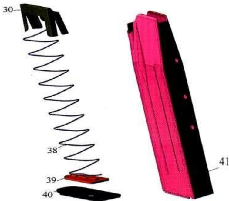
*Рис. 93. Подавач з пружиною і корпус магазину.
