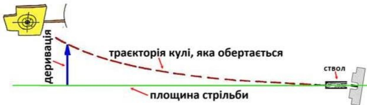
Рис. 127. Відхилення кулі від вертикальної площини стрільби (вигляд зверху)
