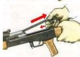
7. Відокремити затворну раму з газовим поршнем. Для цього відвести затворну раму назад до упору, підняти її разом із затвором і відокремити від ствольної коробки.
