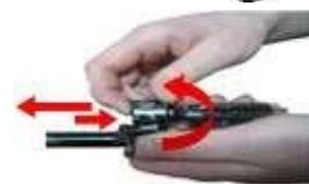
8. **Відокремити газову трубку зі ствольною накладкою.**
