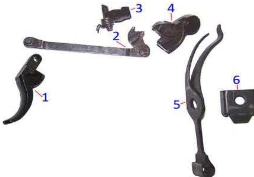
Рис. 68. Ударно-спусковий механізм:
