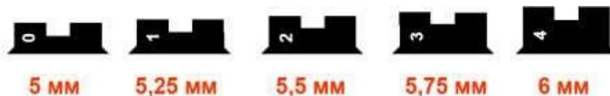
Рис.83. Набір ціликів пістолета Макарова, їх номери і висота
