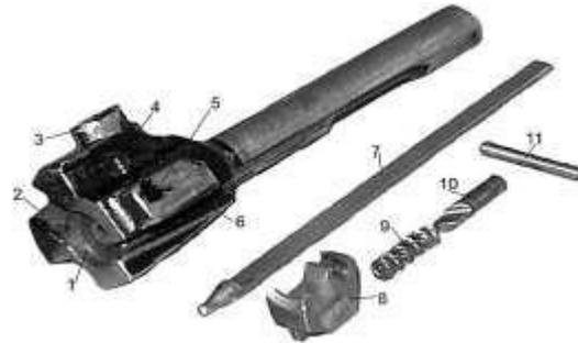
Рис. 23. Затвор (з ударником і викидачем):
