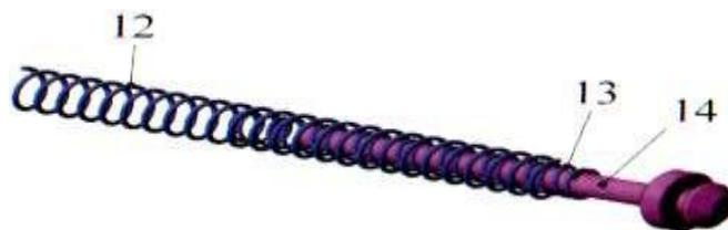
Рис. 88. Направляюча вісь з повертаючими пружинами:
