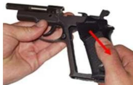
3. **Зняти упор і вилучити бойову пружину з важелем.** Для цього натиснути протиркою на нижню частину упора бойової пружини і просунути його вперед, догори (2), після виходу зачепів упора із зачеплення з рамкою, повільно відвести упор (3) і відокремити важіль від бойової пружини, а пружину – від упора.
