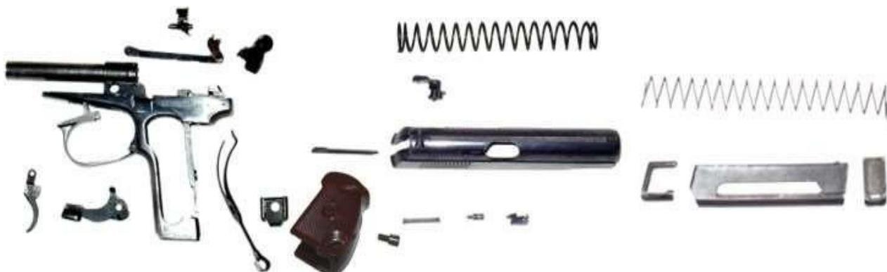
Рис. 79. Частини пістолета після повного розбирання
