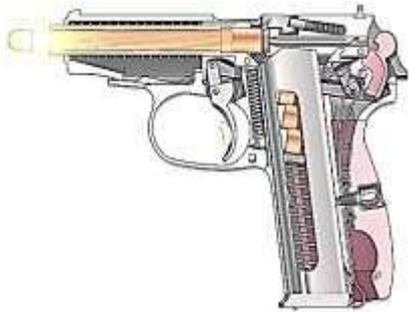
(*передньою частиною*) розбиває капсуль патрона. В результаті цього спалахує пороховий заряд і утворюється велика кількість порохових газів. Куля тиском порохових газів викидається з каналу ствола. Затвор під тиском порохових газів, який передається через дно гільзи,
