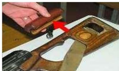
4. **Відокремити кришку ствольної коробки.** Для цього повернути замикач кришки ствольної коробки назад до постановки його на фіксатор, підняти вверх задню частину кришки ствольної коробки і відокремити кришку з повертаючим механізмом.
