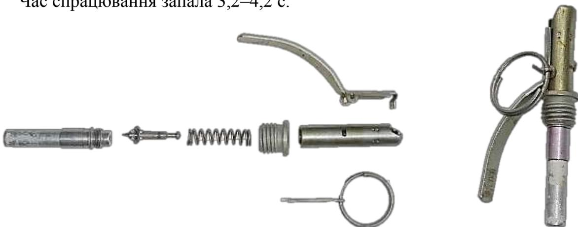
Рис. 108. Універсальний запал УЗРГМ у розібраному і зібраному вигляді
