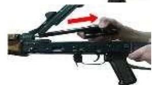
7. **Відокремити затвор від затворної рами.** Для цього узяти затворну раму затвором доверху і відвести затвор назад та повернути його так, щоб ведучий виступ затвора вийшов з фігурного вирізу затворної рами, і вивести затвор вперед.
