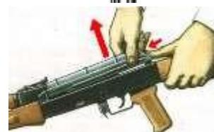
6. Відокремити повертаючий механізм. Для цього натиснути на виступ прямого стержня повертаючого механізму до виходу його п'ятки з повздовжнього паза ствольної коробки, підняти задній кінець прямого стержня і вийняти повертаючий механізм з каналу затворної рами.
