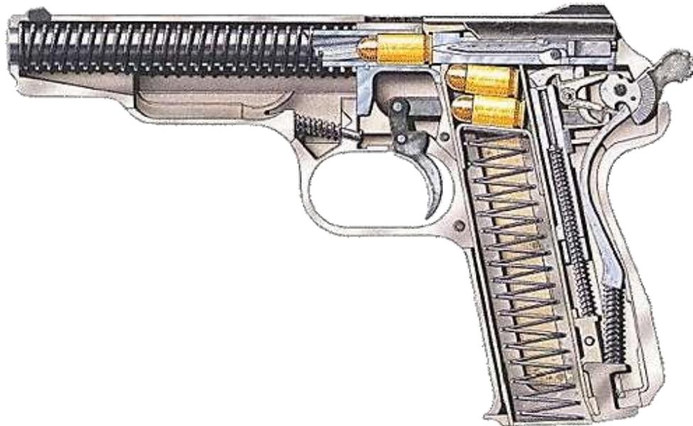
*Рис. 105. Зібраний 9 мм пістолет Стєчкіна в розрізі*
