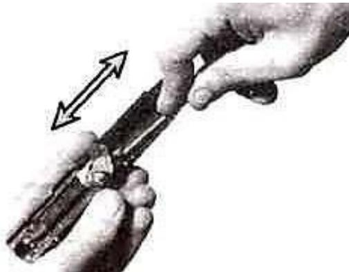
Інші металеві частини і механізми насухо протерти ганчір'ям до повного усунення бруду і вологи, для цього можна використовувати дерев'яні палички.
