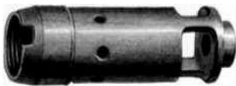
В автоматах АК-74 (АКС-74) (з не укороченим стволом) з боку дульного зрізу ствола накручується **дульне гальмо-компенсатор**, яке за рахунок відповідно розташованих прорізів та отворів у ньому розсіює і скеровує потік порохових газів, які виходять з дульного зрізу ствола вслід за кулею, чим пригальмовує та дещо компенсує віддачу зброї, що дає змогу покращити купчастість стрільби чергами.
