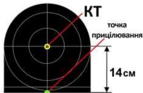
діаметром **8 см**, але СТВ відхилилася від КТ більше ніж на **3 см**, потрібно визначити відхилення СТВ і внести відповідні виправлення в установці гайок на маховиках кутів прицілювання та бокових поправок. Переміщення гайок на одну
