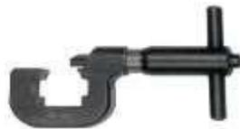
Рис. 82. Пристосування для зміщення цілика ПМ і АПС
