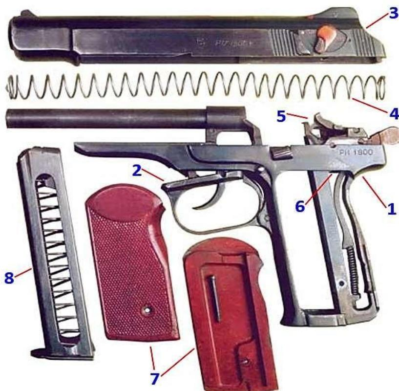
Рис. 104. Основні частини 9 мм пістоleta Стечкаїна
