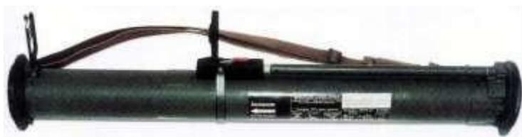
*Рис. 117. Реактивна протитанкова граната РПГ-26*
