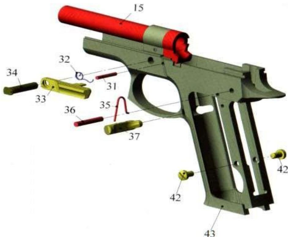
*Рис. 89. Рамка зі стволом та спусковою скобою:*
