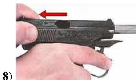
і, припіднявши його задній кінець (9), дати йому можливість просунутись по стволу вперед під дією повертаючої пружини (10).
