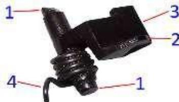
Рис. 71. Шептало з пружиною:
