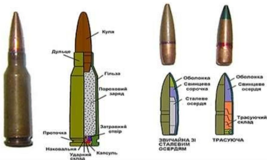
Рис. 5. Будова автоматного патрона 5,45x39 мм та його кулі: зі сталевим осердям і трасуючої
