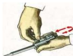
9. Відокремити газову трубку зі ствольною накладкою. Для цього повернути замикач газової трубки до вертикального положення і зняти газову трубку з газової камери.
