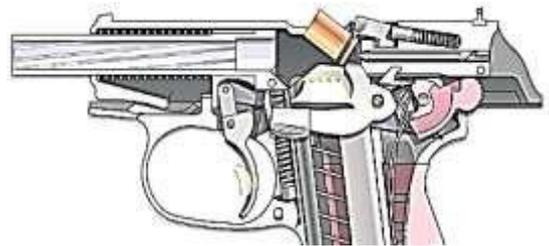
Затвор під час відходу в крайнє заднє положення повертає курок на цапфах назад й ставить його на бойовий звід – притиснене своєю пружиною до курка шептало носиком впирається в бойовий звід курка. Відійшовши назад до упору, затвор під дією повертаючої пружини повертається вперед.
