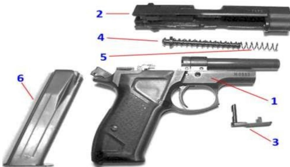
Рис. 86. Основні частини 9 мм пістолета «Форт-12»
