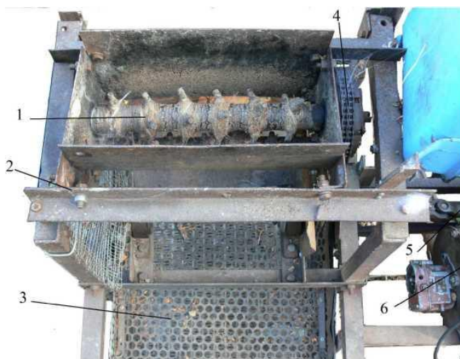
Рис. 3.6 Вид подрібнювального апарату шишко-подрібнювача Полещук В.А.: 1 - дробильний вал, 2 - корпус дробильного апарата, 3 - верхнє решето, 4 - ланцюговий привод дробильного вала, 5 - вал відбору потужності, 6 - двигун
