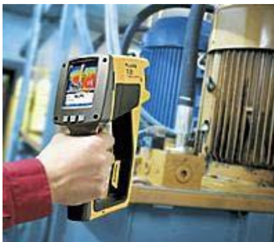
Рис. 11.2. Процес обстеження тепловізором працюючого агрегату
