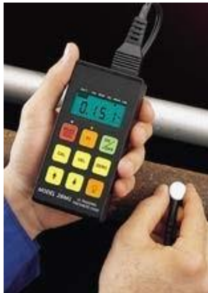
Рис. 10.5. Вимірювання товщини стінки труби ультразвуковим товщиноміром
