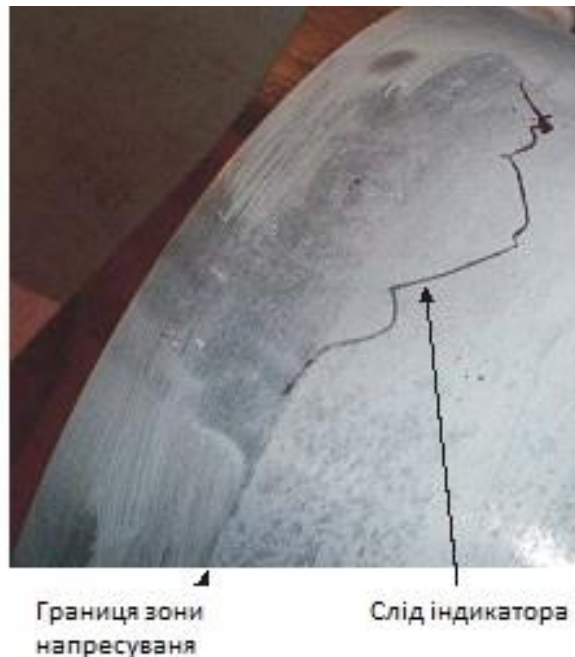
Рис. 4.14. Приклад виявлення капілярним методом тріщини в гребному валу теплоходу
