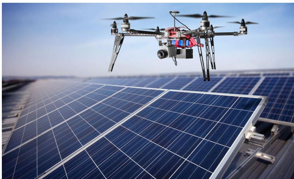
Рис. 6.5. Контроль сонячних панелей за допомогою теплового дефектоскопа-дрона
