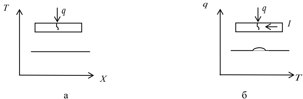
Рис. 5.6. Температура на поверхні ОК в процесі нагрівання: а) ГЧ-випромінювачем, б) індукційним нагрівачем
