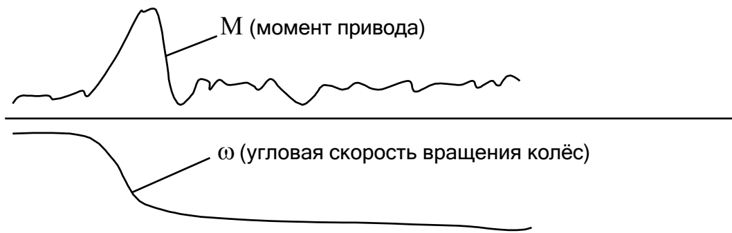
Рисунок 1.1 – Приклад осцилограми механізму пересування козлового крану
