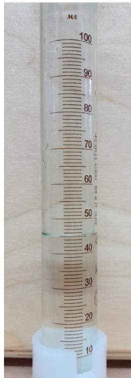
Рис. 4. До задачі 5: дослід з вимірювання питомої теплоємності: а) нагрівання циліндра в киплячій воді; б) вимірювання початкової температури води; в) вимірювання максимальної температури води після занурення циліндра; г) вимірювання об'єму води в калориметрі та об'єму досліджуваного циліндра
