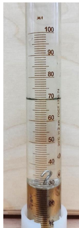
Рис. 4. До задачі 5: дослід з вимірювання питомої теплоємності: а) нагрівання циліндра в киплячій воді; б) вимірювання початкової температури води; в) вимірювання максимальної температури води після занурення циліндра; г) вимірювання об'єму води в калориметрі та об'єму досліджуваного циліндра
