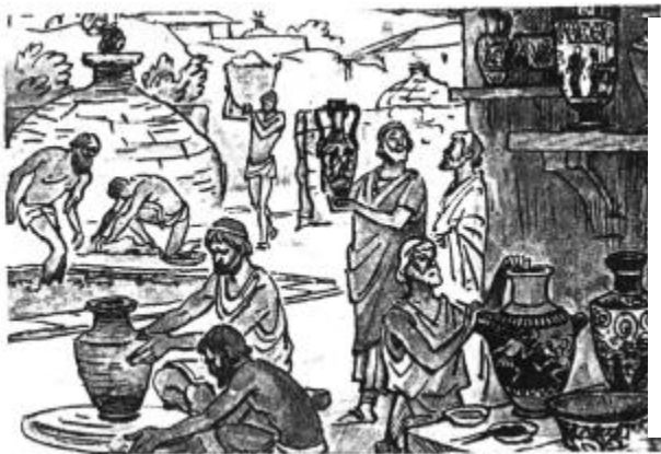
Рисунок 1. 8 – Гончарна майстерня та гончарний круг з приводом від ніг
