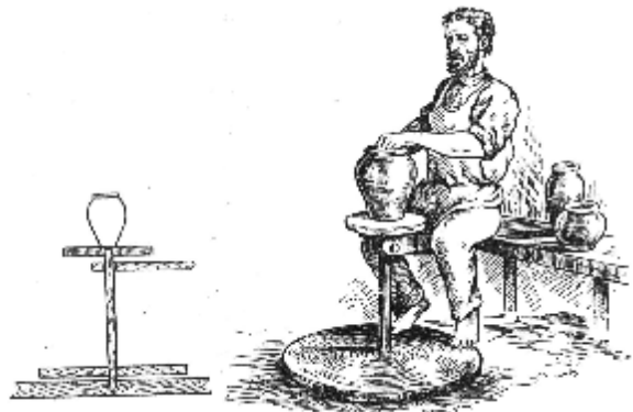
Рисунок 1. 8 – Гончарна майстерня та гончарний круг з приводом від ніг
