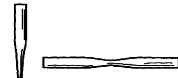
Мал. 22. Виготовлення капілярних трубок
