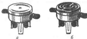
Рис. 27. Електричні плитки: а - закритого типу, б - із відкритою спіраллю
