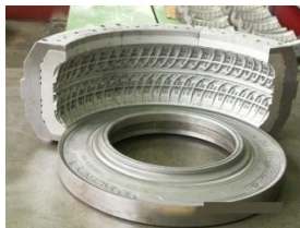
Рисунок 6.20 – Прес-форма для формування і вулканізації шини
