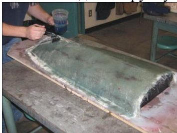
Рисунок 6.36 – Викладання та просочення скломату вручну
