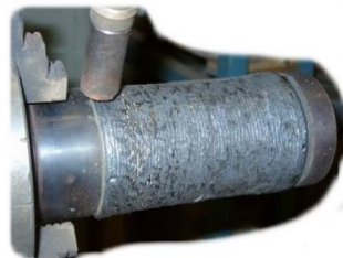
Рисунок 5.29 – Схема наплавлення на циліндричну поверхню
