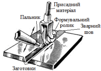
Рисунок 6.40 – Схема зварювання нагрітим повітрям
