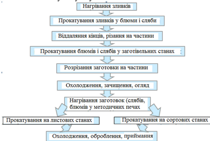
Рисунок 4.17 – Загальна схема технологічного процесу прокатування
