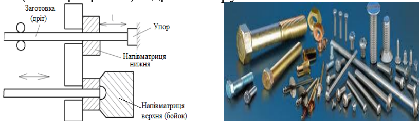
Рисунок 4.36 – Схема штампування висадженням (а) та отримувані заготовки (б)
