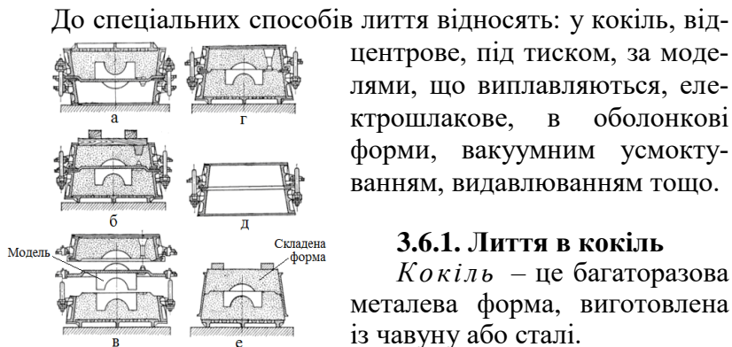
Рисунок 3.14 – Технологічні етапи безопокового формування
