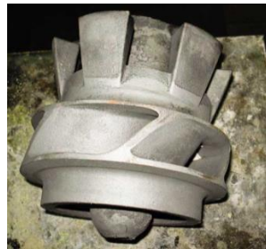
Рисунок 3.1 – Виліток робочого колеса насоса з ливниковою системою, додатками
