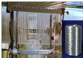
Рисунок 6.38 – Формування труби намотуванням склоровингу
