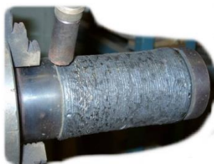
Рисунок 13.29 – Схема наплавлення на циліндричну поверхню
