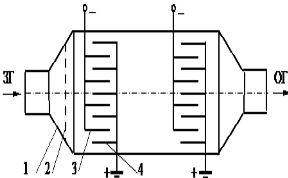
Рисунок 7.2 – Конструктивна схема однозонного двосекційного електрофільтра: 1 – корпус; 2 – газорозподільна решітка; 3 – система коронувальних електродів; 4 – осаджувальні електроди
