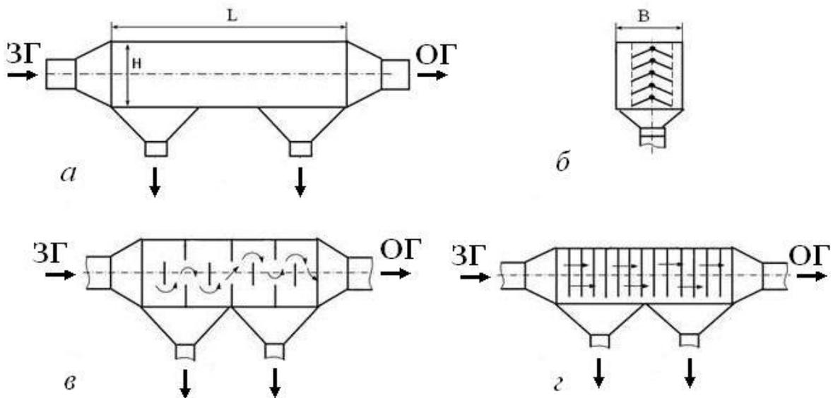
Рисунок 2.1 – Схеми пилоосаджувальних камер: *a* – найпростіша конструкція з розширенням пилопроводу; *б* – багатополична; *в* – з перегородками; *г* – з ланцюговими чи дротяними завісами; ЗГ – рух забрудненого газу; ОГ – рух очищеного газу
