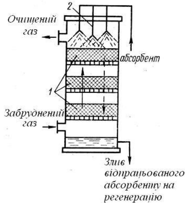
Рисунок 6.1 – Схема абсорбційної колони: 1 – подача абсорбенту; 2 – насадка
