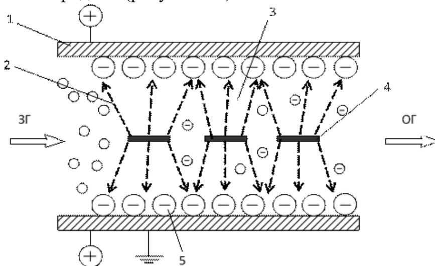
Рисунок 7.1 – Принцип роботи електрофільтра: 1 – осаджувальний електрод; 2 – електричне поле; 3 – заряджена зона; 4 – коронувальний електрод; 5 шар осівшого пилу
