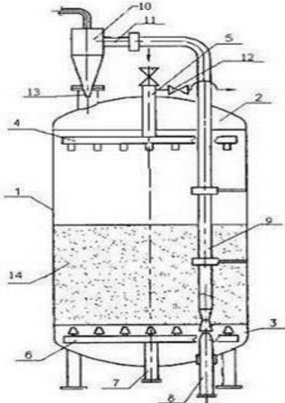
Рисунок 8.1 - Напірний зернистий фільтр SPF-2,0/0,25-RO: 1 - корпус фільтра; 2 - кришка; 3 - піддон; 4 - зборно-розподільча система; 5 - подача води на фільтрування; 6 - дренажна система; 7 - відвод очищеної води; 8 - подача води на гідроелеватор; 9 - гідроелеватор; 10 - напірний гідроциклон; 11 - подача пісчаної пульпи в напірний гідроциклон з гідроелеватора; 12 - відвод забрудненої промивочної води; 13 - конус вигрузки відмитих відновлених часток; 14 - загрузка фільтра.
