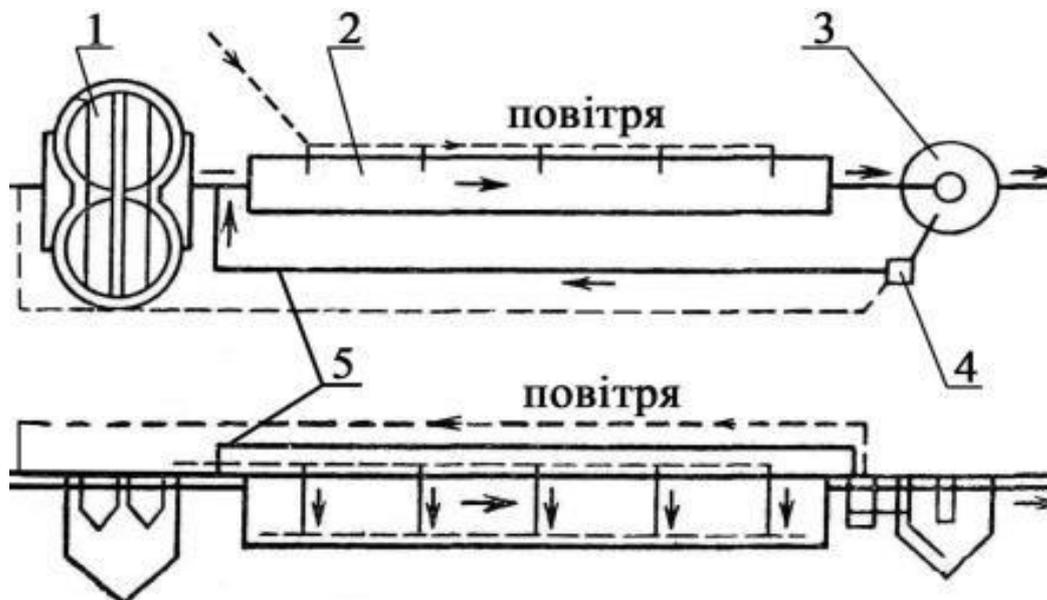
Рисунок 10.1 – Схема аеротенку розрахованого на повне очищення: 1 – двоярусний басейн; 2 – аеротенк; 3 – вторинний відстійник; 4 – насосна станція; 5 – активний мул, який циркулює
