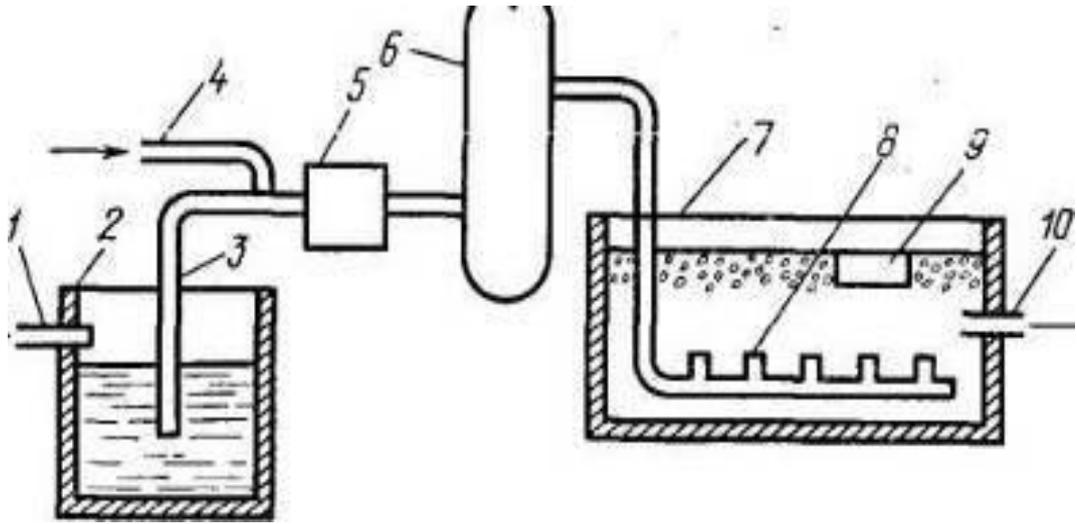
Рисунок 9.1 – Напірний флотатор: 1 - труба стока; 2 – прприймальний резервуар; 3 - всмоктуюча труба; 4 – труба; 5 – насос; 6 – сатуратор; 7 - флотаційна камера; 8 - сопло, 9 – пінозбірник; 10 - труба (очищена вода).
