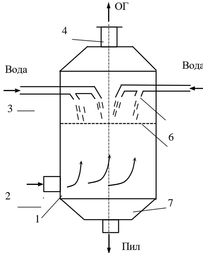
Рисунок 3.1 – Порожнинний форсунковий скрубер: 1 – корпус; 2 – патрубок подання запиленого газу; 3 – патрубок подання води; 4 – патрубок відведення очищеного газу; 5 – форсунки; 6 – газорозподільна решітка; 7 – бункер для шламу
