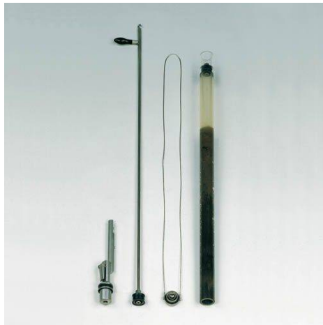
Рис. 5.2. Пробовідбірник донних відкладень Р 12.42 універсальний.
