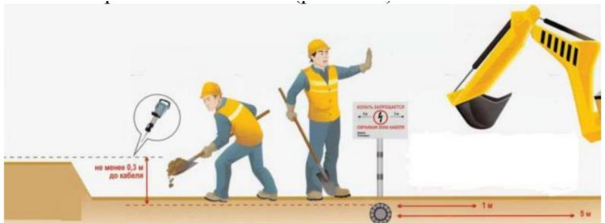
Рис. 1.25. Землерийні роботи в охоронній зоні електрокабелів, прокладених у ґрунті
