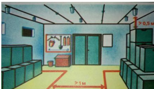
Рис. 7.2. Вимоги пожежної безпеки при зберіганні матеріалів у складських приміщеннях
