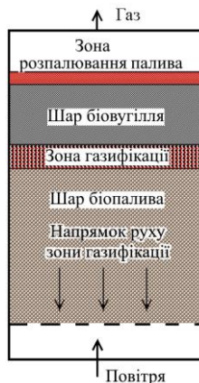
Рис. 4.25. Схема газогенератора оберненого процесу з рухомою зоною газифікації
