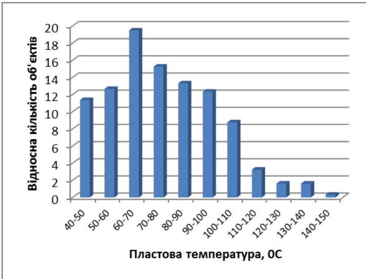
Рис. 6.10. Розподіл пластової температури продуктивних горизонтів у геотермальних об'єктах з електронної бази даних
