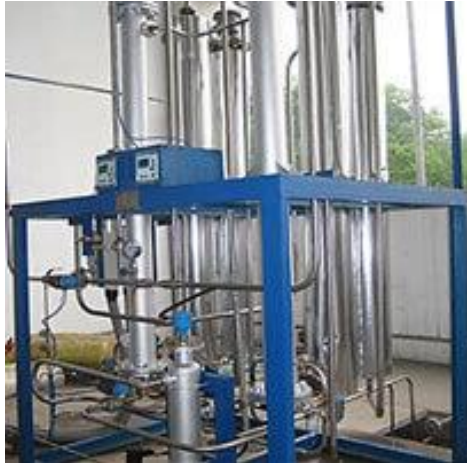
Рис. 8.7. Комплексна система отримання електролітичного водню
