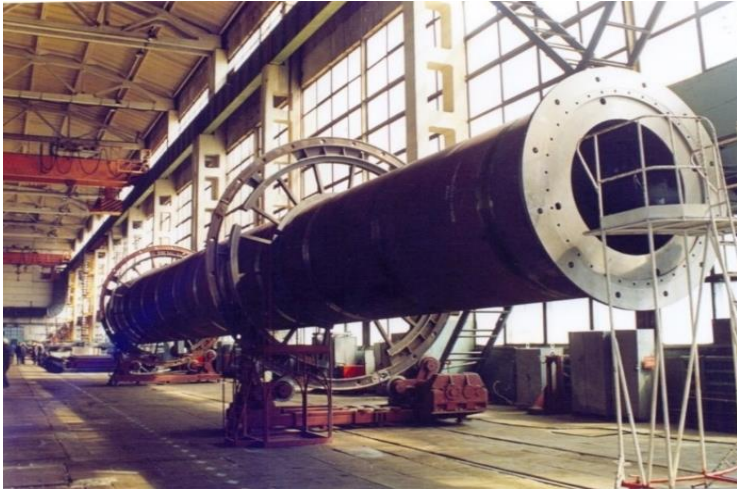
Рис. 2.28. Виробництво веж вітротурбіни Т600-48 на ДП «Виробниче об'єднання Південний машинобудівний завод ім. О.М. Макарова»
