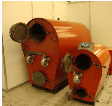
Рис. 4.6. Схема та загальний вигляд піролізних котлів
