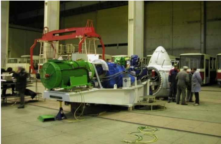
Рис. 2.27. Збирання модуля вітротурбіни Т600-48 на ДП «Виробниче об'єднання Південний машинобудівний завод ім. О.М. Макарова»
