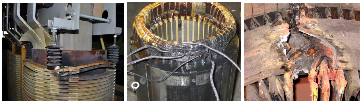
Рисунок 9.1 – Пошкодження обмоток трансформатора й електричних машин через КЗ
