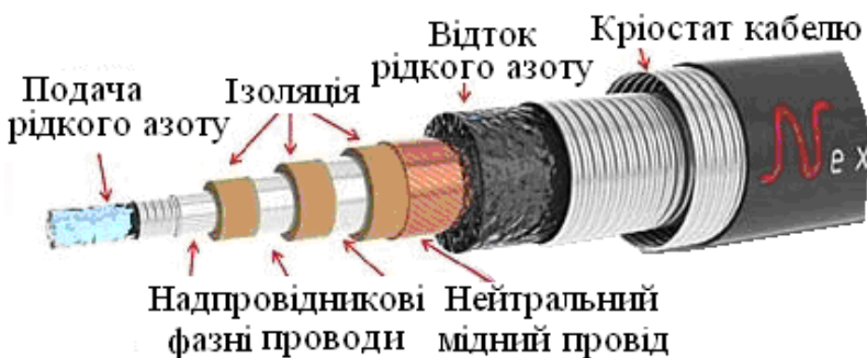
Рисунок 3.11 – Надпровідниковий кабель на основі використання ВТНП
