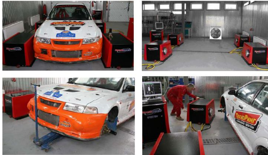
Рисунок 3.8 – Технологія діагностування на комп'ютеризованому стенді типу Dynapack 6033 4WD
