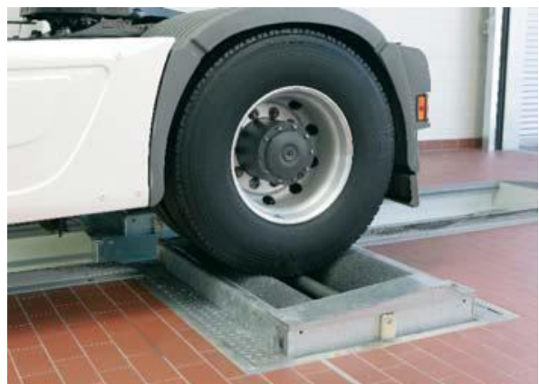
Рисунок 3.5 – Комп'ютеризований гальмівний стенд: а – загальний вигляд; б – установка ТЗ на бігові барабани
