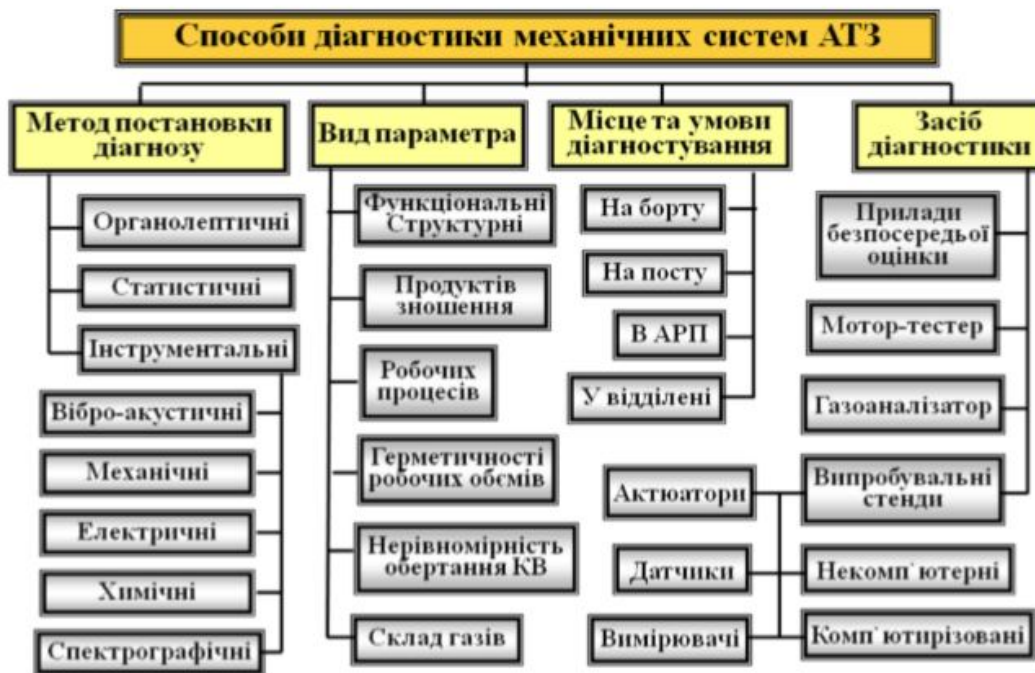
Рисунок 3.4 – Класифікаційна структура способів діагностування механічних систем
