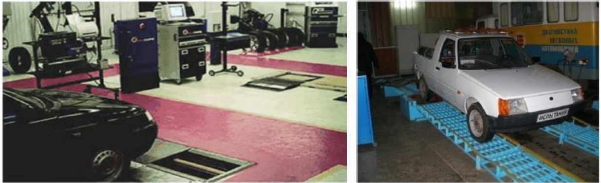
Рисунок 3.9 – Пости експрес-діагностики: а – стаціонарний діагностичний комплекс; б – мобільний діагностичний комплекс
