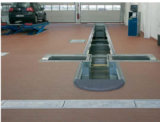
Рисунок 3.5 – Комп'ютеризований гальмівний стенд: а – загальний вигляд; б – установка ТЗ на бігові барабани
