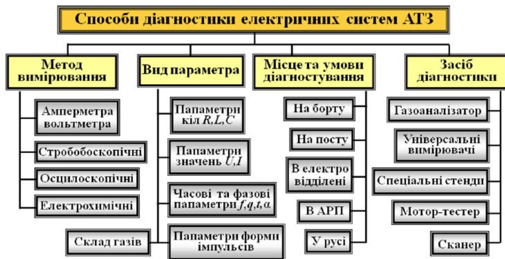
Рисунок 3.10 – Класифікація способів діагностування електричних систем
