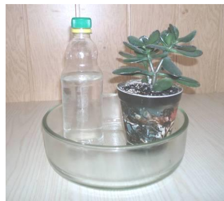
Рис. 7.6. Пристрій для автоматичного поливу кімнатних рослин (діюча модель)
