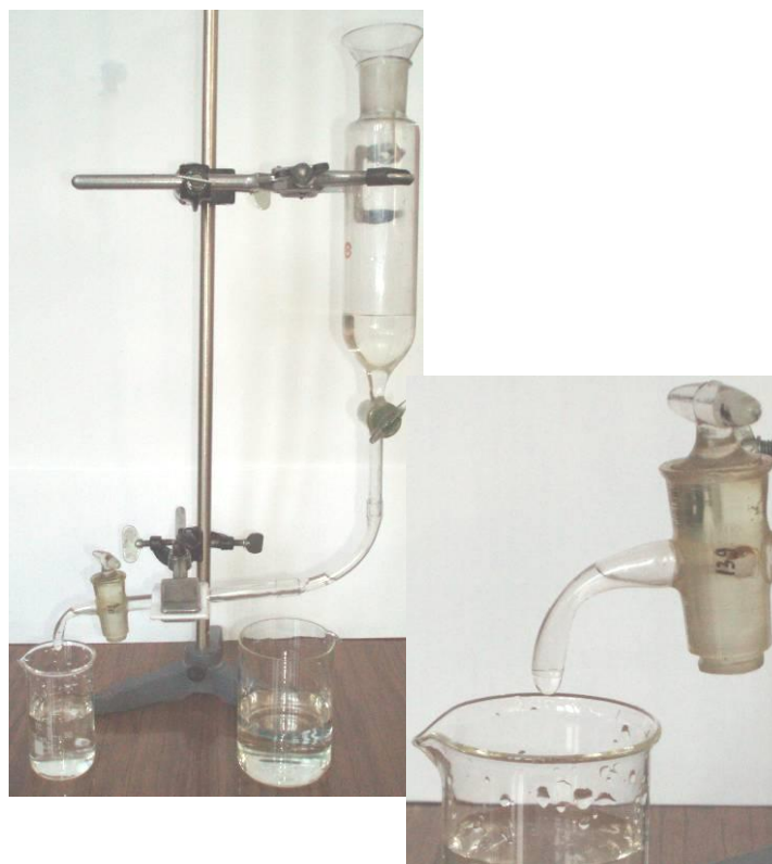
Рис. 7.2. Експериментальна установка для вимірювання коефіцієнта поверхневого натягу методом відриву крапель
