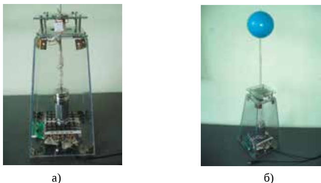
Рис. 2.5. Експериментальний зразок анемометра (патент України № 43782 [2]): а) загальний вигляд; б) реєструюча частина приладу
