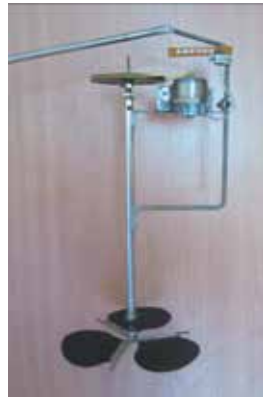
Рис. 2.19. Хвильова енергетична установка з гнучкими лопатями: а) схема; б) діюча модель
